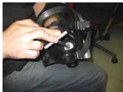
Insgesamt wurden dabei Materialien im Gesamtwert von 553,37 Euro getauscht bzw. neu eingebaut (Ventilscheiben, Sprech-Membrane, Ventilteller, O-Ringe, etc.). Im Zuge dieser Überprüfung wurden auch alle Lungenautomaten der Atemschutzgeräte einer eingehenden Inspektion unterzogen und dabei 9 Membrane getauscht. Gesamter Zeitaufwand in Eigenregie: 13 Stunden.
